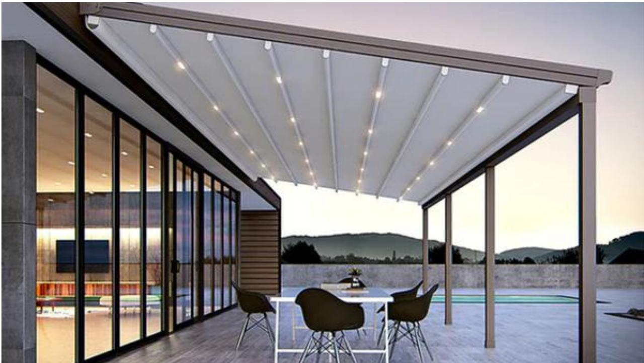
Le toit de la pergola classique est couvert par un tissu de protection solaire. Celui-ci est rétractable grâce à un système s'appuyant sur des roulements, afin que vous modifiez l'exposition au soleil en fonction des heures de la journée. Pour vous faciliter la tâche, le toit rétractable peut être **automatisé**. Le moteur est alors **pilotable à distance**. La toile est aussi prévue pour résister à la pluie qui glisse dessus, comme sur les plumes d'un canard.
